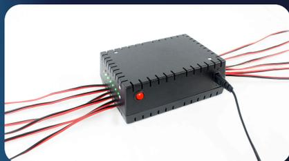
ЗУ-12 рассчитан на одновременную зарядку до двенадцати тагеров, повязок и жилетов. Габариты: длина — 175 мм, ширина — 125 мм, высота — 65 мм. Длина провода — 120 см. Напряжение и ток: Вход: 176-264V AC 0,9 А. Выход: 4,2V DC 0,8 А
